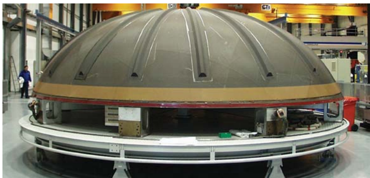
Druckkalotte des Airbus aus CFK, hergestellt von der CTC GmbH
