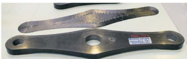
Die CFK-Schwinge für das Höhenleitwerk eines Airbus. Deutlich zu erkennen sind die Fasern, die bewusst in Richtung des Kräfteverlaufs gewebt wurden.
