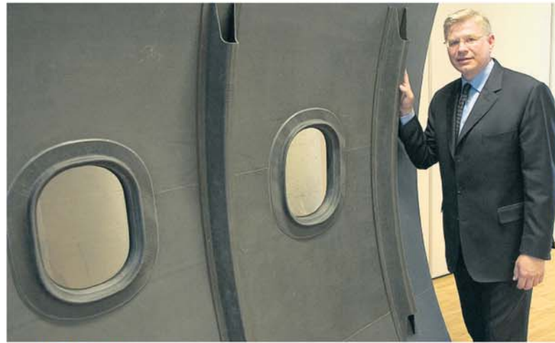
Axel Herrmann , die treibende Kraft hinter dem Technologiezentrum Stade, vor dem Segment eines zukünftigen Flugzeugrumpfes aus Kohlenstofffaser. Hier sind Isolierungen und Verbindungskabel bereits in die Rumpfschalen integriert. Noch ist dieser „CFK-Rumpf der 2. Generation“ aber Zukunftsmusik.
