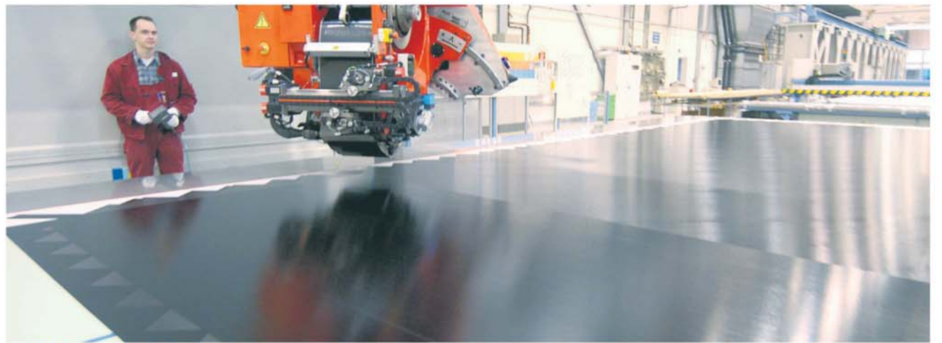
Das Zuschneiden der Kohlenstoffasermatten im Airbus-Werk in Stade. Hier werden die CFK-Seitenleitwerke für die Airbus-Flieger hergestellt. Das Zuschneiden ist zwar teilweise automatisiert, aber jeder Schritt muss dennoch von einem Fachmann überwacht werden, um Fehler zu vermeiden. Foto: dpa
